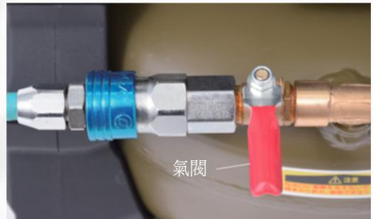
2 後拉快速接頭的環後，風管就會脫落。此時，如果在風管內的空氣還沒完全排出的狀態下進行的話，可能會使風管噴出。所以請完全排出空氣。另外，以防萬一請手持風管將其拆除。
